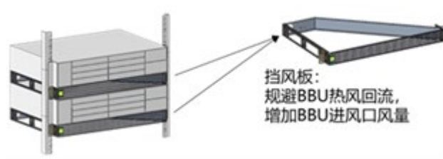
图8.6.1-2 BBU 横装方式挡风板安装示意图
