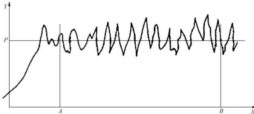
图 6 90° 剥离载荷位移曲线示意图
