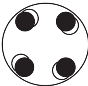
图6 法兰螺栓孔的找正
