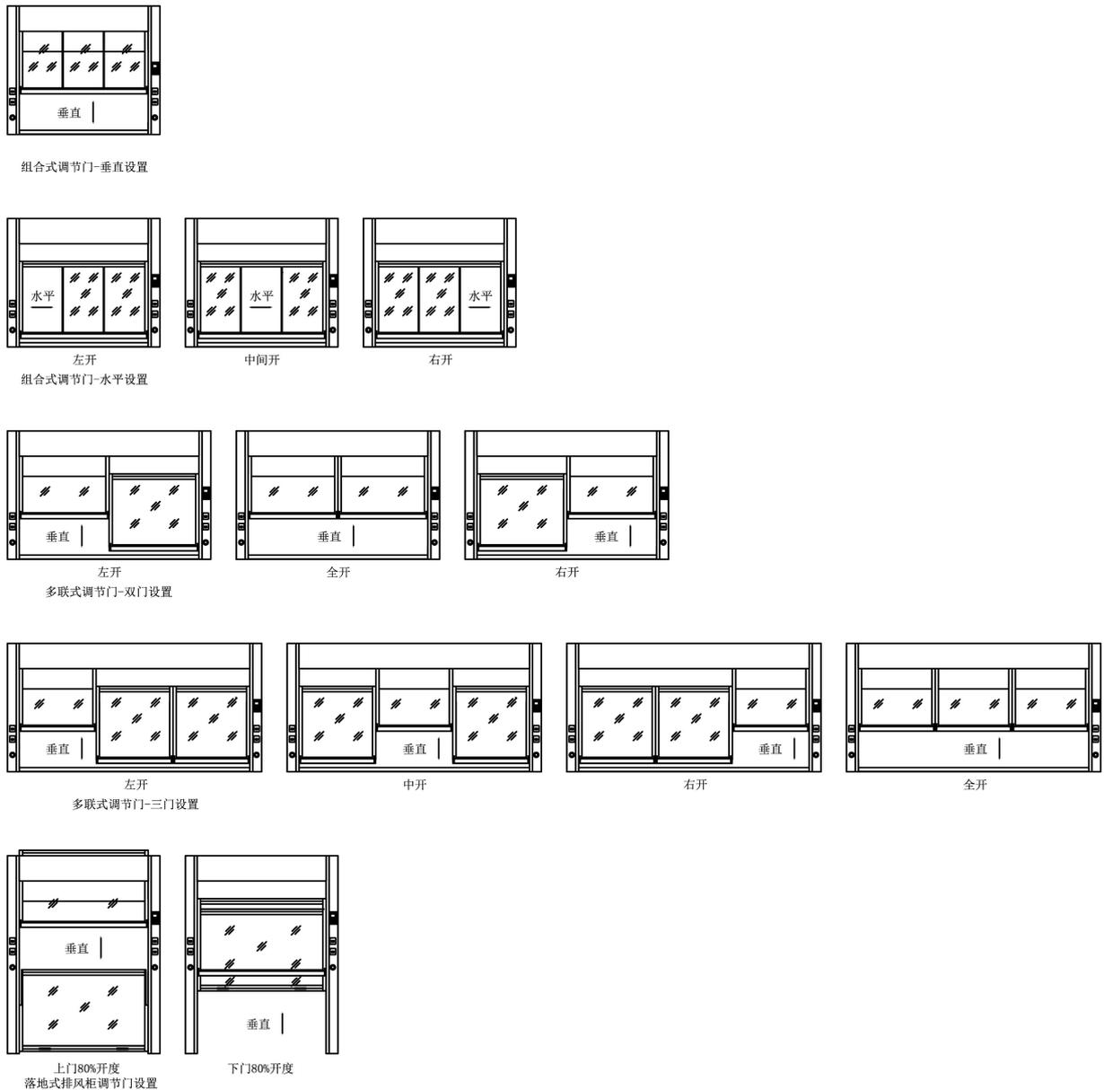
图E.1 调节门试验操作开口设置
