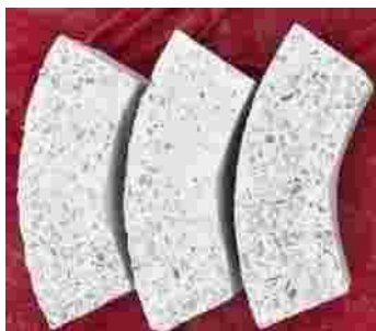
图 1.6 粘度对 C20 混凝土磨蚀的表面形貌 (8 m/s), 左至右依次为粘度 8.95 \times 10^{-4} \text{ Pa} \cdot \text{s} , 0.067 \text{ Pa} \cdot \text{s} , 0.163 \text{ Pa} \cdot \text{s} 固相比 0.05, 碎石级配 4
