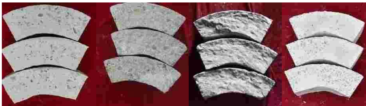
图 1.8 粘度对 C25 混凝土磨蚀的表面形貌 (8 m/s), 左至右依次为粘度 8.95 \times 10^{-4} \text{ Pa} \cdot \text{s} , 0.067 \text{ Pa} \cdot \text{s} , 0.163 \text{ Pa} \cdot \text{s} , 0.29 \text{ Pa} \cdot \text{s} 固相比 0.05, 碎石级配 4
