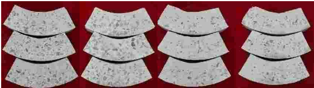
图 1.25 不同标号混凝土的磨损情况（向右依次 C20，C25，C30，C40，速度 8m/s）
