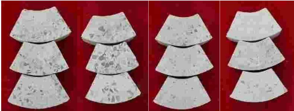
图 1.24 不同标号混凝土的磨损情况（向右依次 C20，C25，C30，C40，速度 5m/s）
