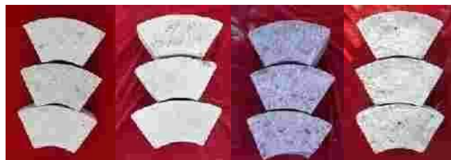
图 1.21 固相比对 C25 混凝土磨蚀的表面形貌 (5 m/s), 左至右依次为固相比 0, 0.05, 0.10, 0.20, 粘度 0.163 \text{ Pa} \cdot \text{s} , 碎石级配 1
