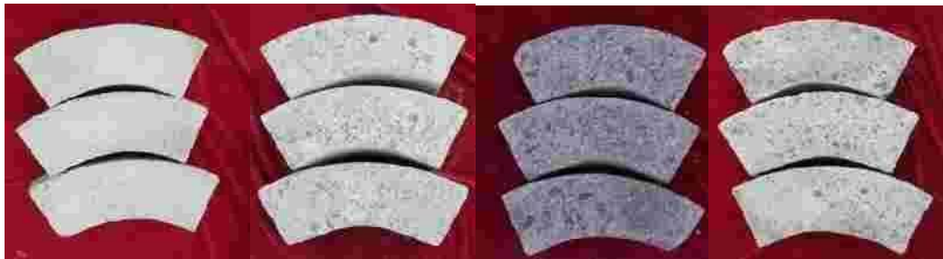
图 1.18 固相比对 C20 混凝土磨蚀的表面形貌（8 m/s），左至右依次为固相比 0，0.05，0.10，0.20，粘度 0.163 Pa·s，碎石级配 1
