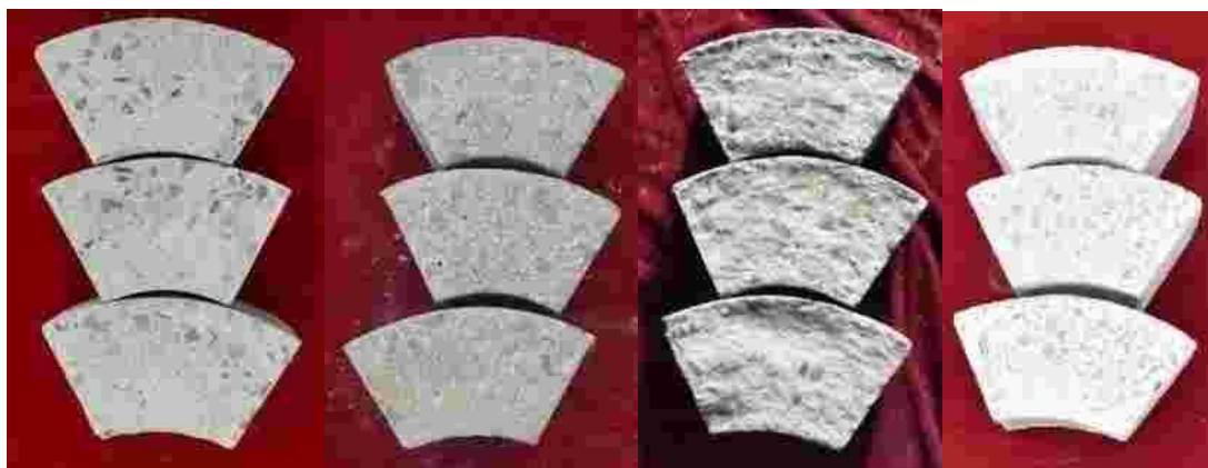
图 1.7 粘度对 C20 混凝土磨蚀的表面形貌 (5 m/s), 左至右依次为粘度 8.95 \times 10^{-4} \text{ Pa} \cdot \text{s} , 0.067 \text{ Pa} \cdot \text{s} , 0.163 \text{ Pa} \cdot \text{s} , 0.29 \text{ Pa} \cdot \text{s} 固相比 0.05, 碎石级配 4
