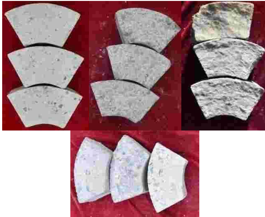
图 1.9 粘度对 C25 混凝土磨蚀的表面形貌 (5 m/s)，左至右依次为粘度 8.95 \times 10^{-4} \text{ Pa} \cdot \text{s} ， 0.067 \text{ Pa} \cdot \text{s} ， 0.163 \text{ Pa} \cdot \text{s} ， 0.29 \text{ Pa} \cdot \text{s} 固相比 0.05，碎石级配 4
