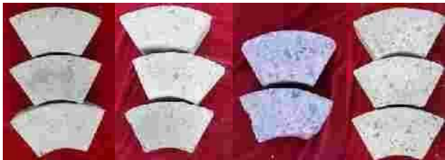
图 1.19 固相比对 C20 混凝土磨蚀的表面形貌（5 m/s），左至右依次为固相比 0，0.05，0.10，0.20，粘度 0.163 Pa·s，碎石级配 1
