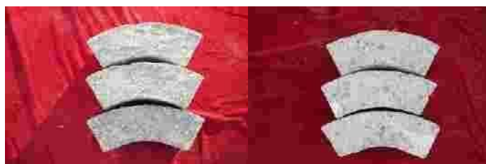
图 1.12 碎石级配对 C20 混凝土磨蚀的表面形貌 (8 m/s)，左至右依次为级配 1, 2, 3, 4, 5, 粘度 0.163 \text{ Pa} \cdot \text{s} , 固相比 0.1
