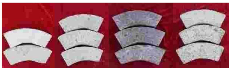
图 1.20 固相比对 C25 混凝土磨蚀的表面形貌 (8 m/s), 左至右依次为固相比 0, 0.05, 0.10, 0.20, 粘度 0.163 \text{ Pa} \cdot \text{s} , 碎石级配 1
