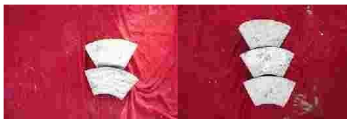
图 1.15 碎石级配对 C25 混凝土磨蚀的表面形貌 (5m/s)，左至右依次为级配 1, 2, 3, 4, 5, 粘度 0.163 \text{ Pa} \cdot \text{s} , 固相比 0.1
