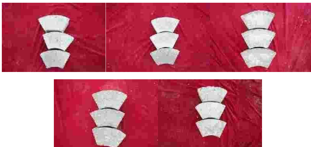
图 1.13 碎石级配对 C20 混凝土磨蚀的表面形貌 (5 m/s)，左至右依次为级配 1, 2, 3, 4, 5, 粘度 0.163 \text{ Pa} \cdot \text{s} , 固相比 0.1
