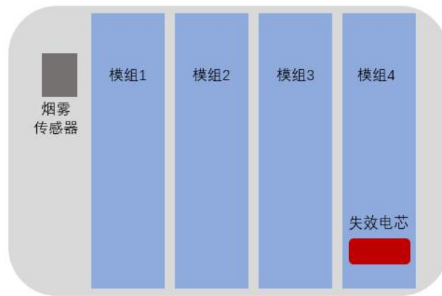
图 D.1 某电池系统电芯热失控和烟雾传感器位置示意图
