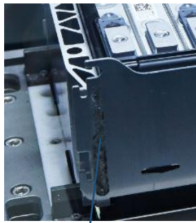
穿透焊：增加板厚提高强度
