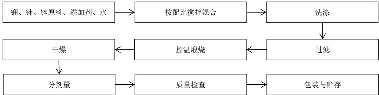
图 1 稀土载锌纳米粉末制备工艺流程图
