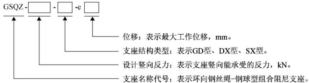
示例：GSQZ-6000-DX-e195表示单向滑动型钢钢丝绳阻尼球型钢支座，支反力为6000kN，最大工作位移为195mm。
