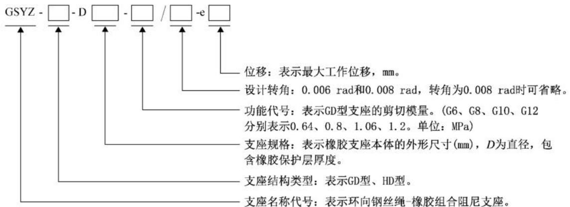
示例：GSYZ-GD-D600-G8/0.006-e157表示固定型钢钢丝绳阻尼橡胶支座，其中的橡胶支座本体直径为600mm，剪切模量为0.8MPa，设计转角为0.006rad，最大工作位移为157mm。
