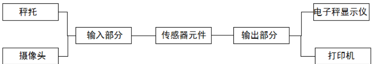
图3 智能电子秤子系统组成架构图
