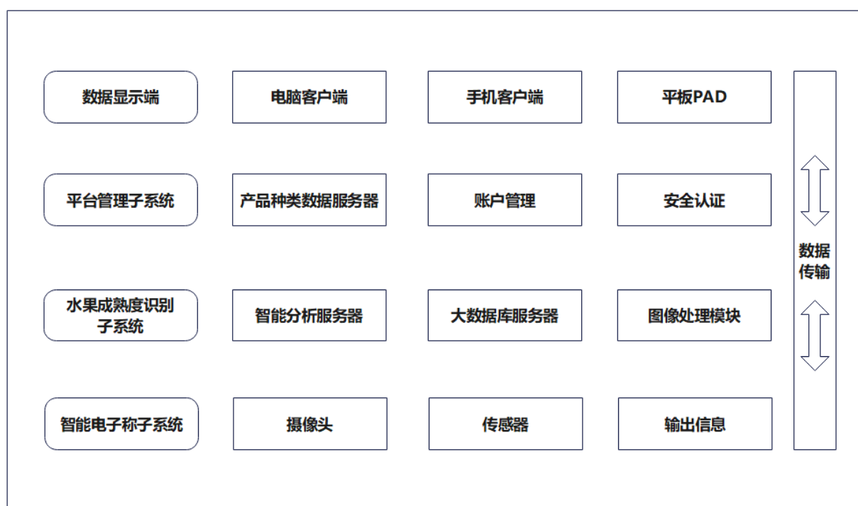
图1 水果成熟度智能识别管理系统组成架构图
