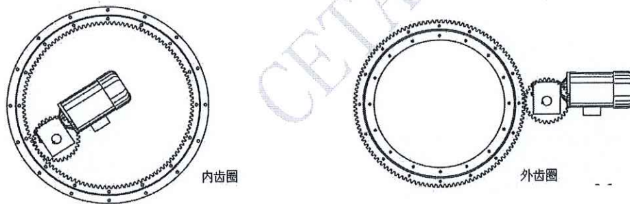
图 A.2 齿轮传动 (销齿传动)
