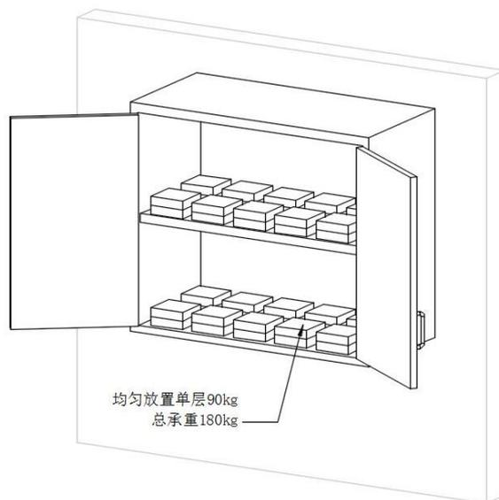
图 22 吊柜荷载试验
