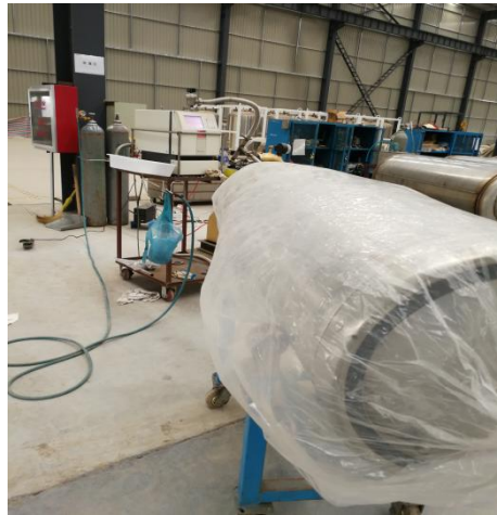
图 2 真空夹层漏气率装置图
