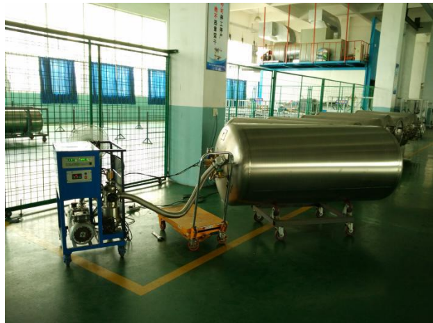
图 4 漏放气速率测试装置图
