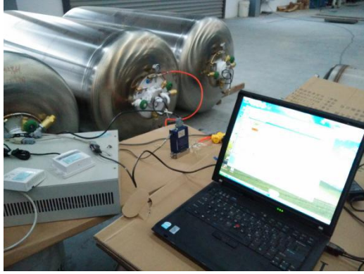
图 6 气瓶蒸发率测试装置图
