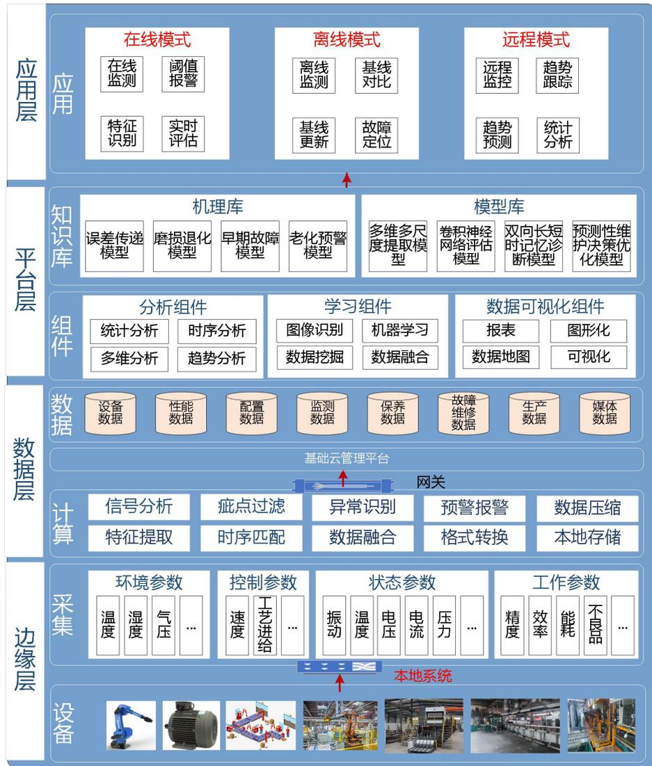
图1 基于CPS的产线设备健康管理架构图
