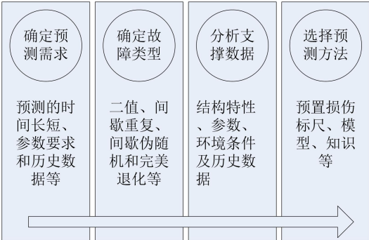
图 1 故障预测设计流程
