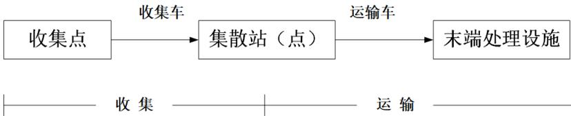
图 2.0.14 集散转运模式示意图
