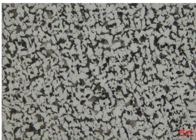
图 A.4 铁素体+珠光体，晶粒度 13.0 级，500×
