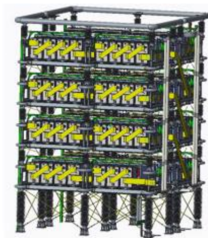
图 1 单相阀塔典型结构
