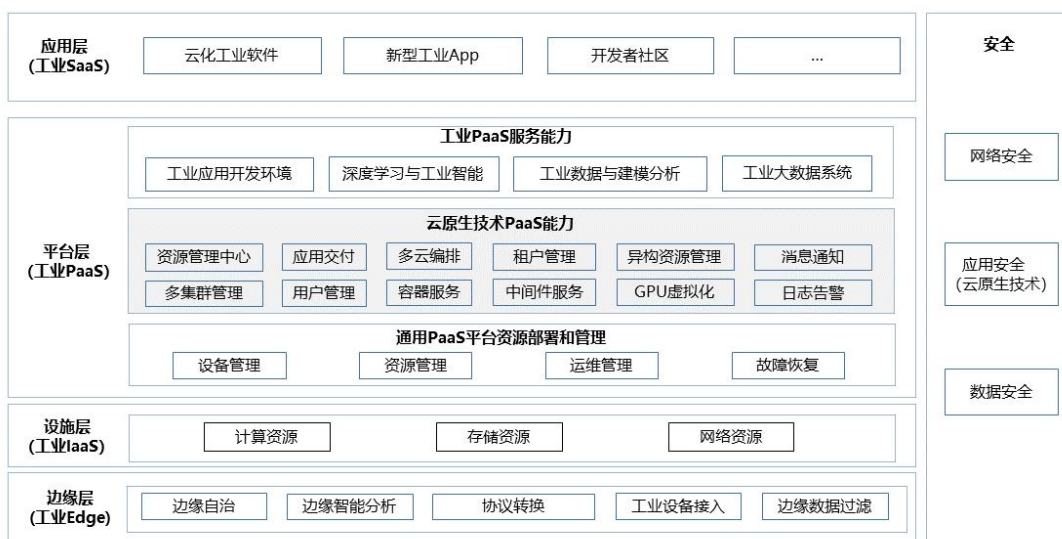
图 1 钢铁行业工业互联网云原生技术参考架构
