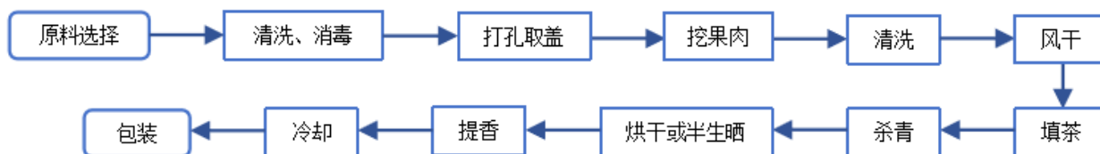
图1 融安金桔茶（青柑茶）工艺流程
