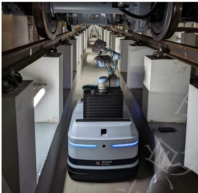
图 4-3 智能巡检机器人采集数据
