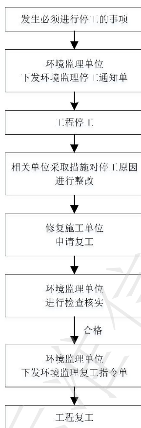
图6 建设用地土壤修复工程停工及复工处理流程图
