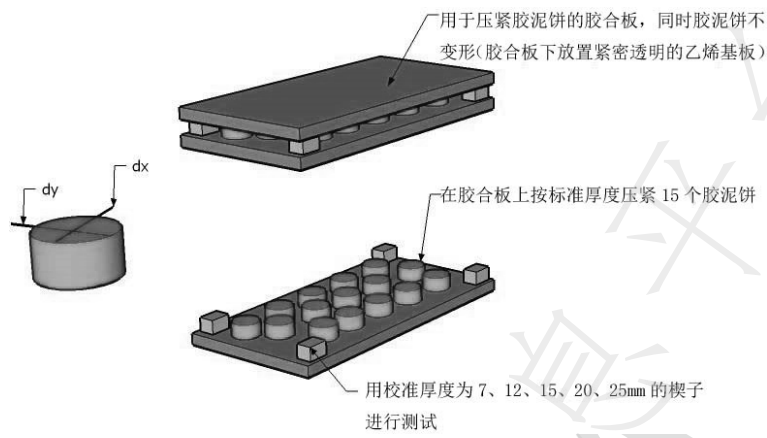
图F.3 胶泥饼尺寸测定示意图
