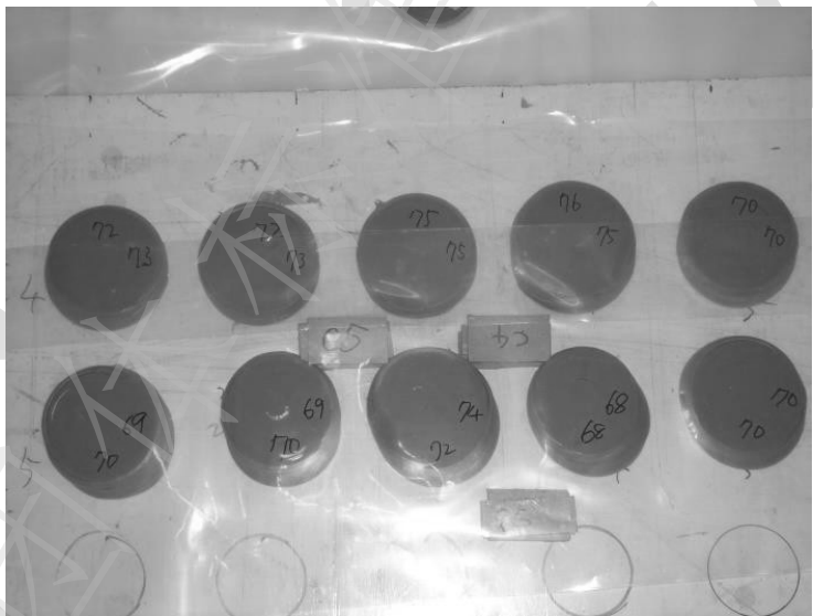
图F.4 胶泥饼挤压测试示意图
