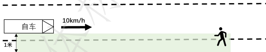
图4 侧向盲区监测预警测试场景
