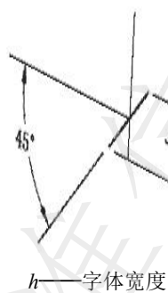
图10 尺寸线终端的斜线
