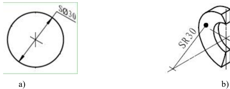
图 27 球面尺寸的注法（二）
