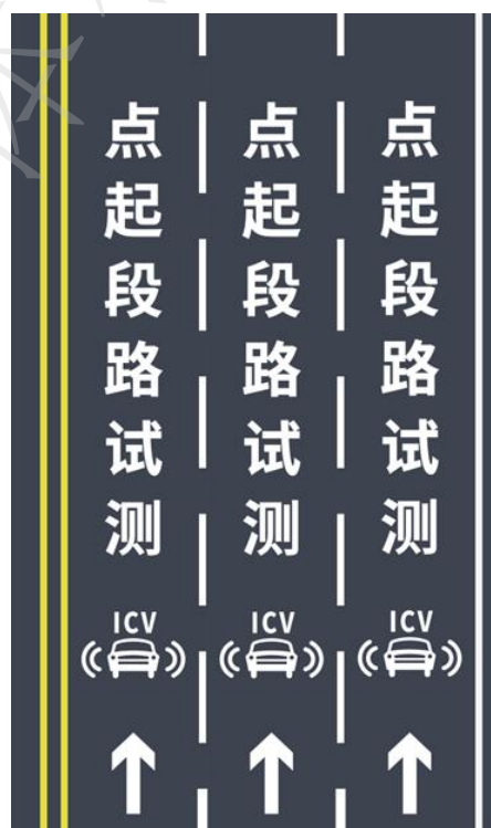
图 B.2 智能网联汽车测试路段（起点）路面标线
