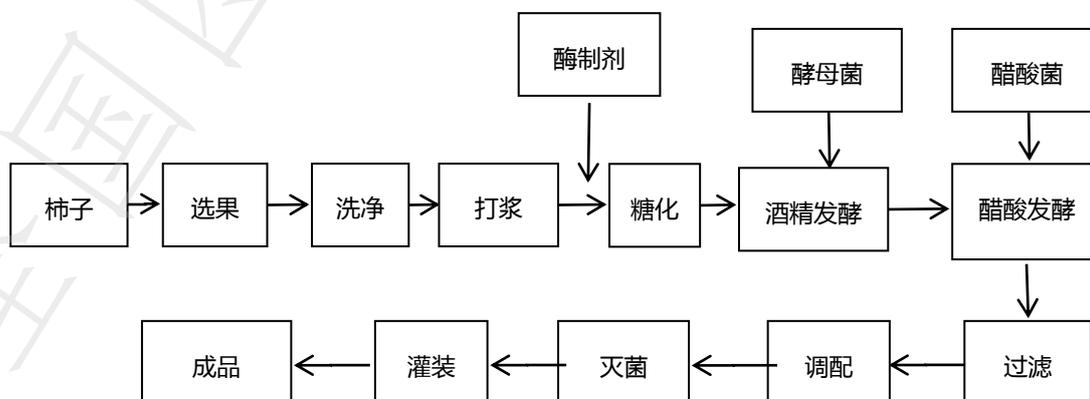
图1 生产工艺流程图
