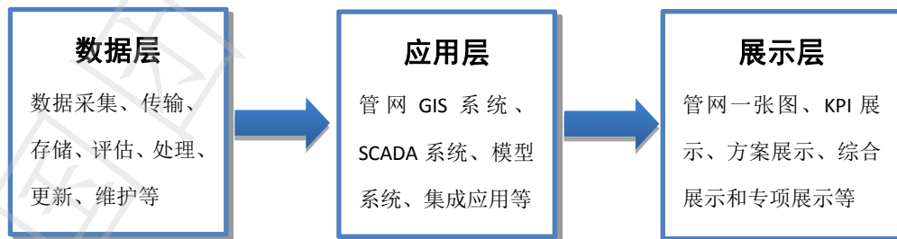
图 1 供水管网数字化技术架构
