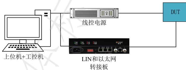
图 12 以太网测试项目的设备架构框图
