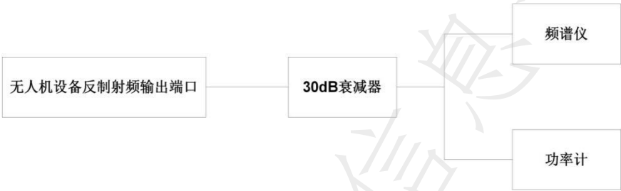
图 C-5 频率和功率测试工况
