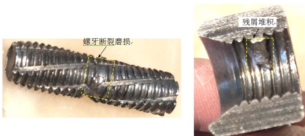
图 C.18 典型 80 级 M12 旋切螺栓咬死分离后螺纹形貌
