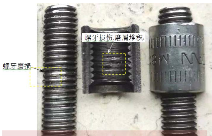
图 C.16 典型 70 级 M6 标准螺栓咬死分离后螺纹形貌
