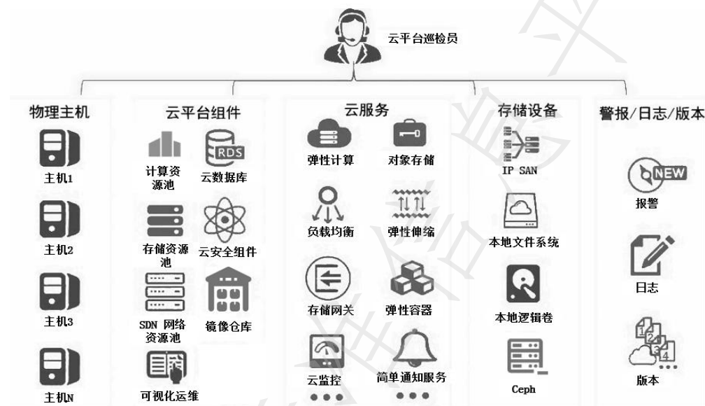
图4 云平台巡检基本架构图
