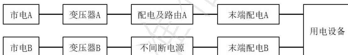
图 2 数据中心一级用负荷供电架构图
