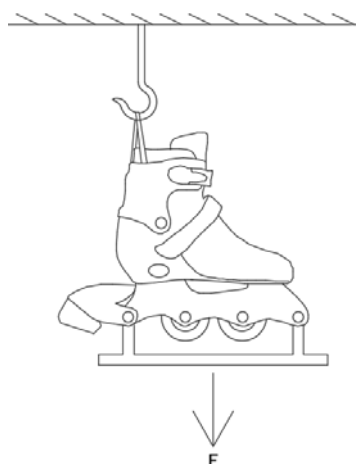
图2 后提带拉力试验示意图
