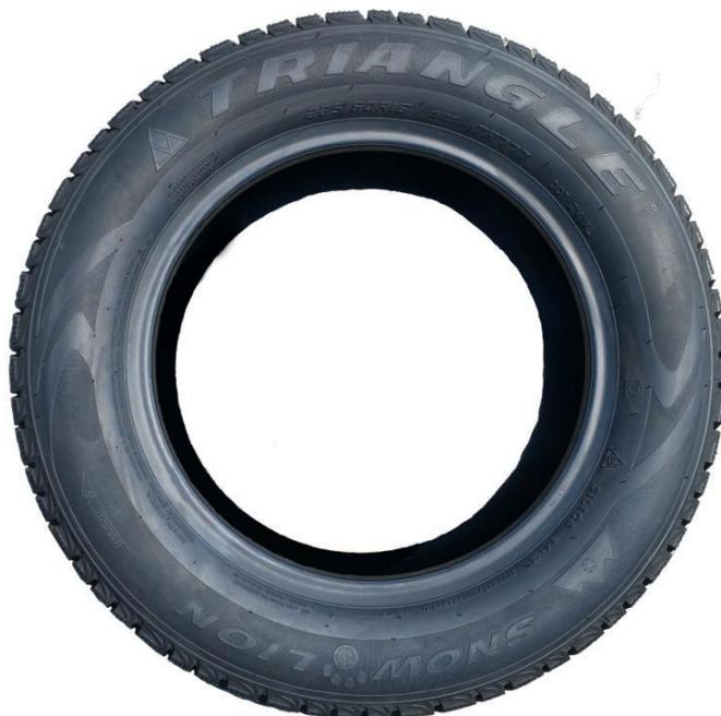
图2 225/60R16 98S 标准测试轮胎侧视图
