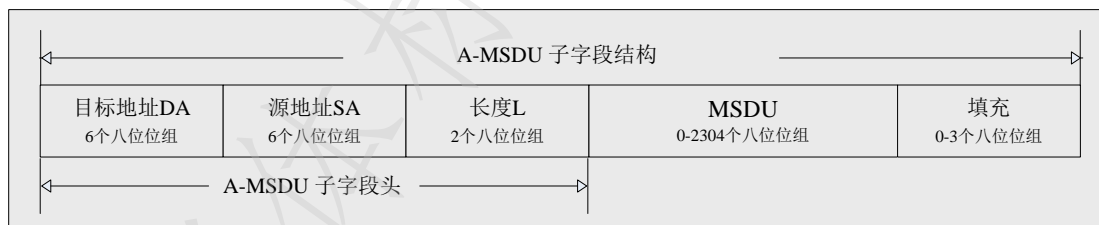
图 2 A-MSDU 子字段结构
