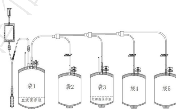
图 A.2 五联顶顶袋
