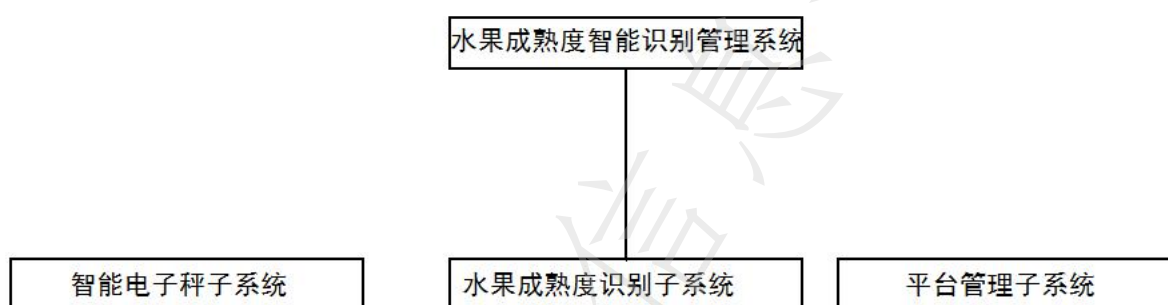
图4 水果成熟度智能识别管理系统组成架构图
