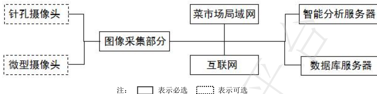
图4.2 智能电子秤子系统组成架构图
