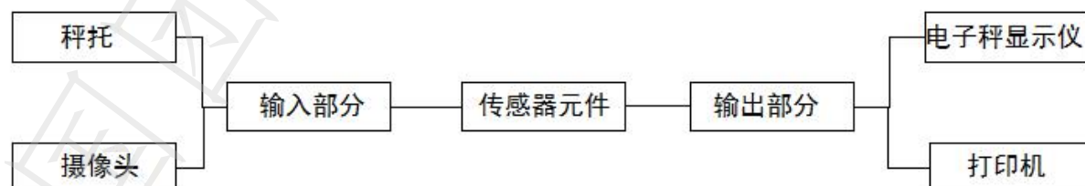
图4.1 智能电子秤子系统组成架构图
