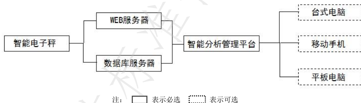
图4.1 平台管理子系统组成架构图
