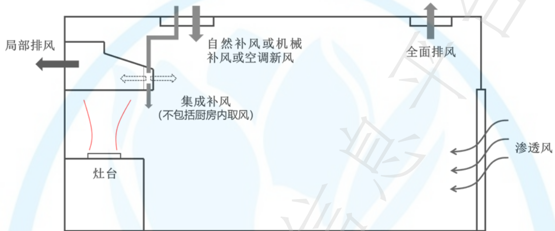
图9.3.1 商用厨房内风平衡示意图
