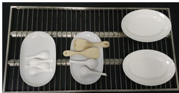
图E.6 第5层蒸鱼盘、饭勺、汤勺、小汤勺的装载图
