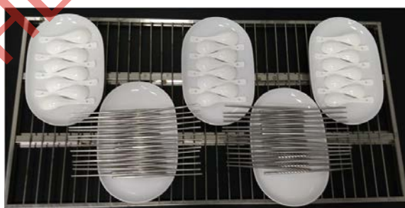
图E.2 第 1 层筷子、小汤勺的装载图
