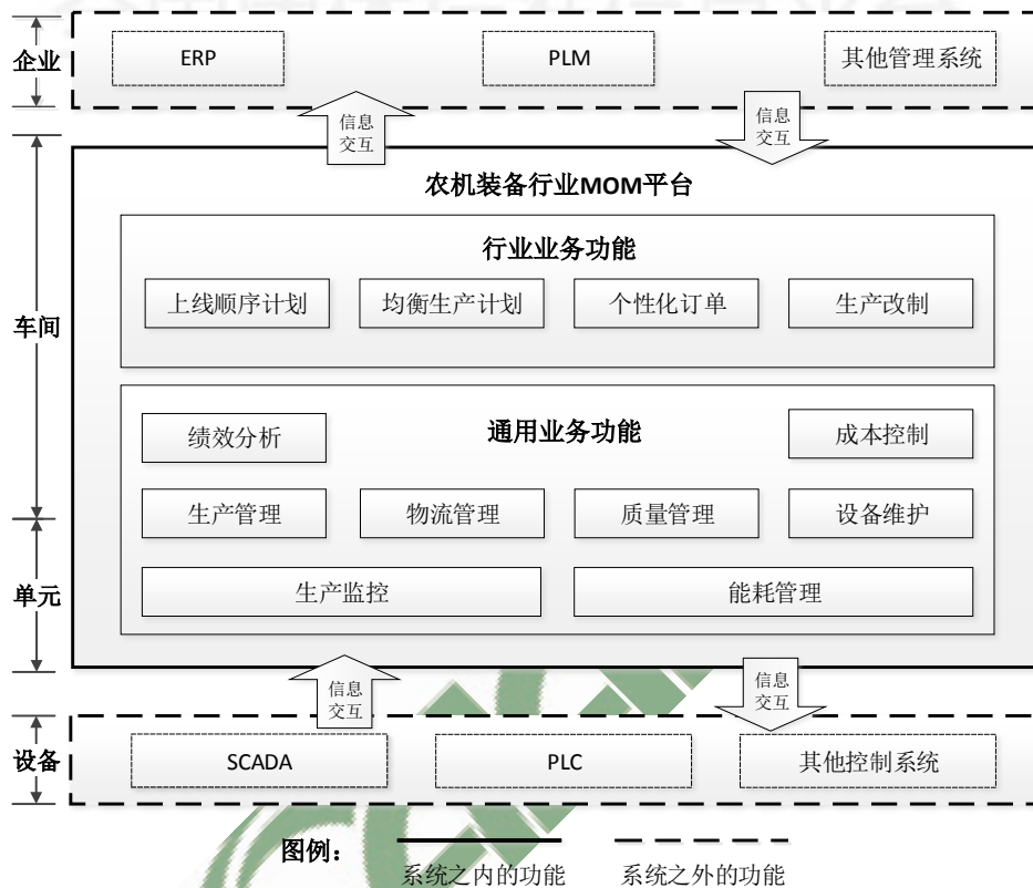
图 1 农机装备智能工厂制造运行系统架构
