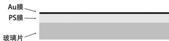
图 1 玻璃衬底上 PS/Au 双层膜体系示意图
