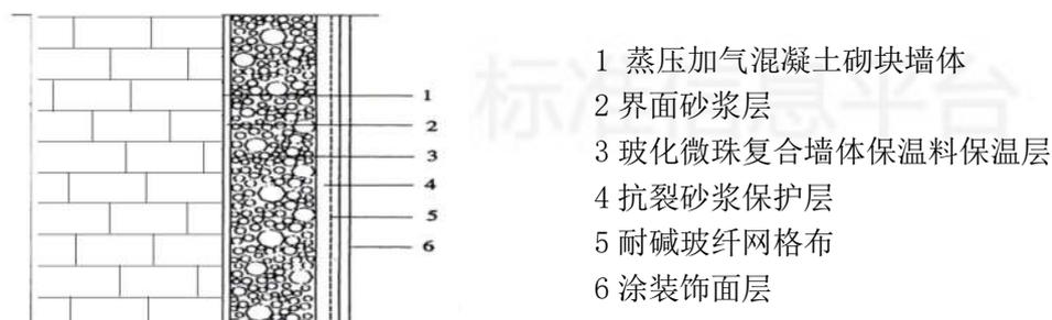
图 5.3.1 图装饰面基本构造
