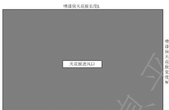
图 B.3 上送下排气流组织送风口位置示意图
