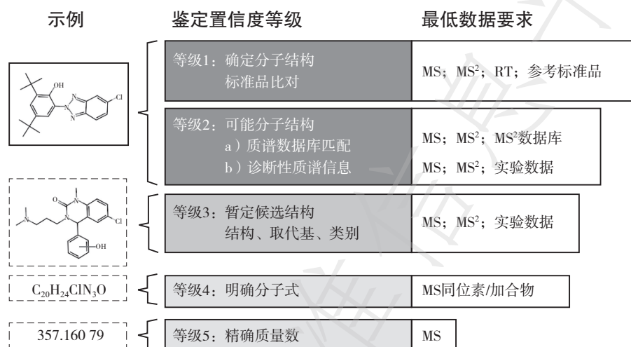
图 6 非靶标筛查新污染物中置信度水平分级方法
