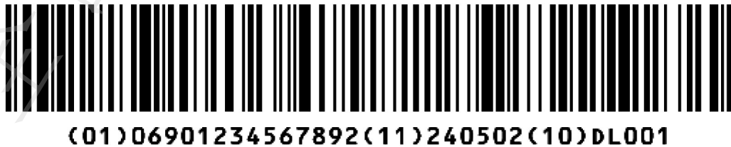
图 B.3 含批次信息的定量通信行业物资 GS1-128 条码的符号示例
