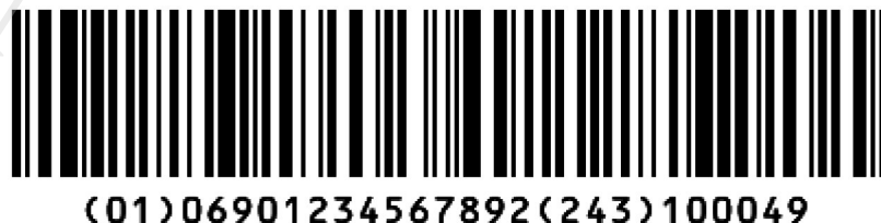
图 B.7 多种物资组合的通信行业物资 GS1-128 条码的符号示例
