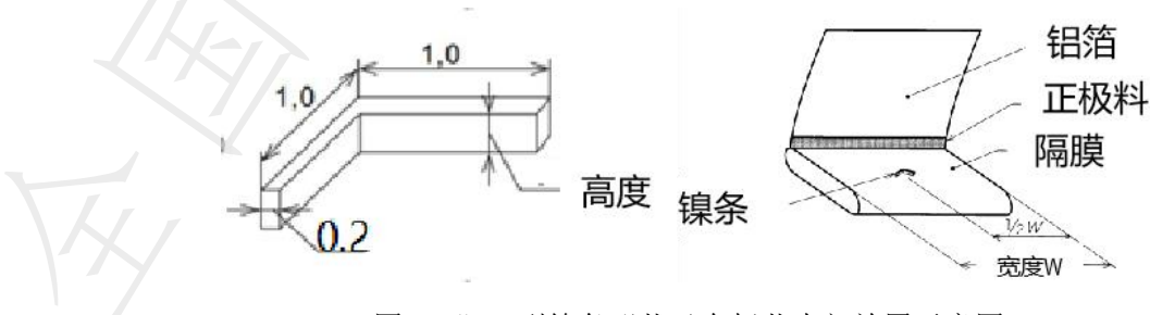
图 1. “L”型镍条形状及在极芯内部放置示意图
