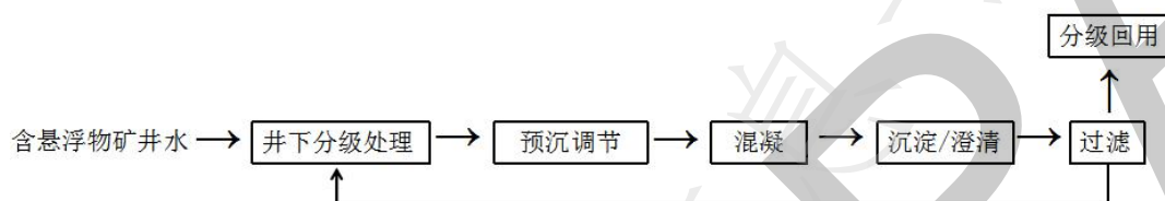
图2 含悬浮物矿井水井下处理与回用基本流程图
