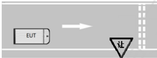
图7 识别及响应减速让行标志标线测试场景
