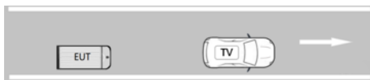
图18 识别及响应前方静止车辆测试场景
