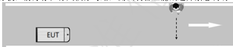
图34 识别及响应机动车道行人突然窜出测试场景
