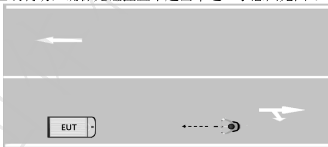
图19 非机动车逆向行驶测试场景示意图
